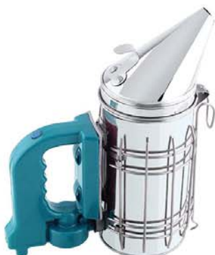
0868 Dimilica inox, električna , Ø 100mm, h=280mm - prednost ovog proizvoda je što za rad koristi 4 standardne baterije 1.5V, obezbeđujući konstantan protok vazduha.
